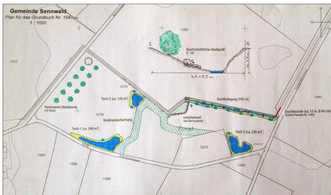
Ausführungsplan zum Baugesuch vom 14.08.2008 mit der Lage der drei Flachteiche und der Bachfreilegung entlang der Grundstücksgrenze. Die grüne Schraffur bezeichnet den Bereich der Waldrandaufwertung. Plan HJR.
